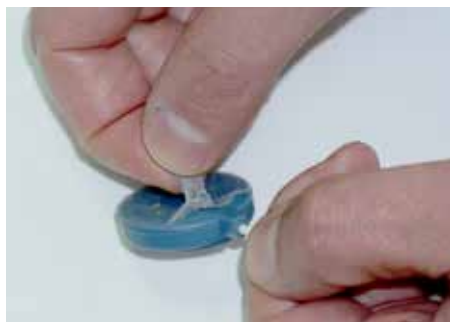
Attēls 26 – Krūšu sensora uzlīmes noņemšana
