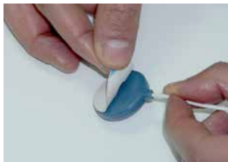
Attēls 27 – Krūšu sensora uzlīmes pielīmēšana
