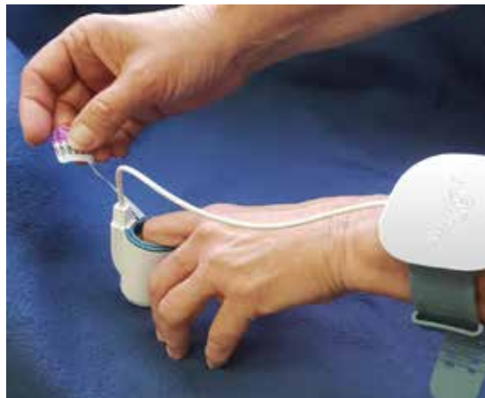
Figur 8 – Fjern flappen markeret med TOP, mens du trykker mod en hård overflade
