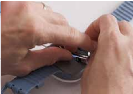
Figur 29 – Isætning af batteri
