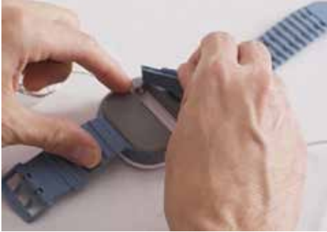
Figuur 28 – Verwijder batterij
