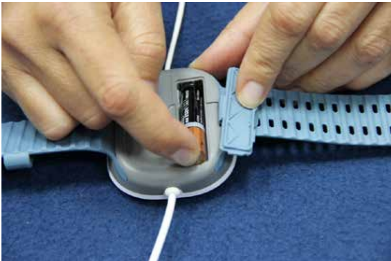
Figuur 4 – Batterij plaatsen
