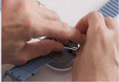
Figuur 29 – Batterij plaatsen
