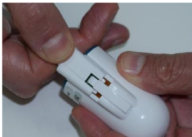
Figure 23 - Nouvelle connexion du capteur de doigt
