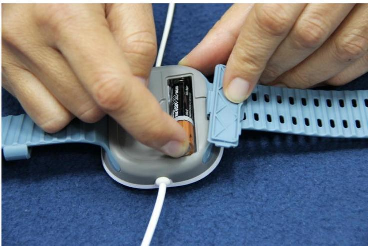
**Abbildung 4 – Einlegen der Batterie**
