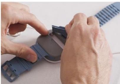
**Abbildung 26 – Entnahme der Batterie**
