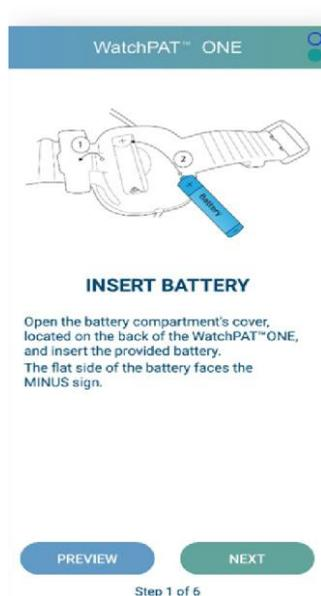
**Abbildung 12 – Bildschirmanzeige für das Einlegen der Batterie**
