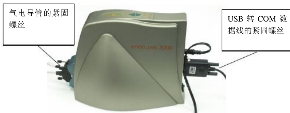
图 3 – 气电导管和 USB 数据线的连接
