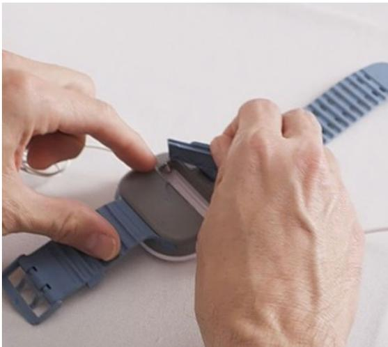
Figura 26 – Retiro de la batería
