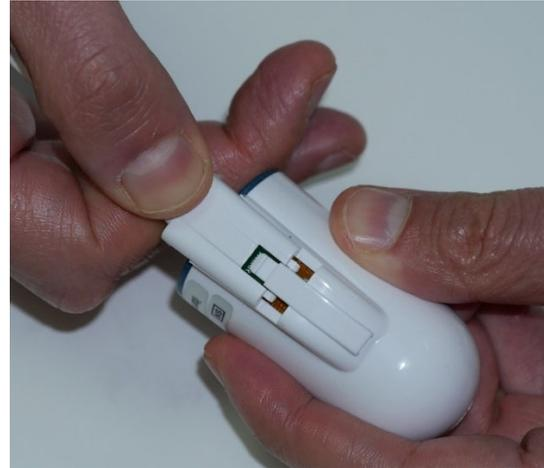
**Figura 23 – Conexión de la nueva sonda de dedo**
