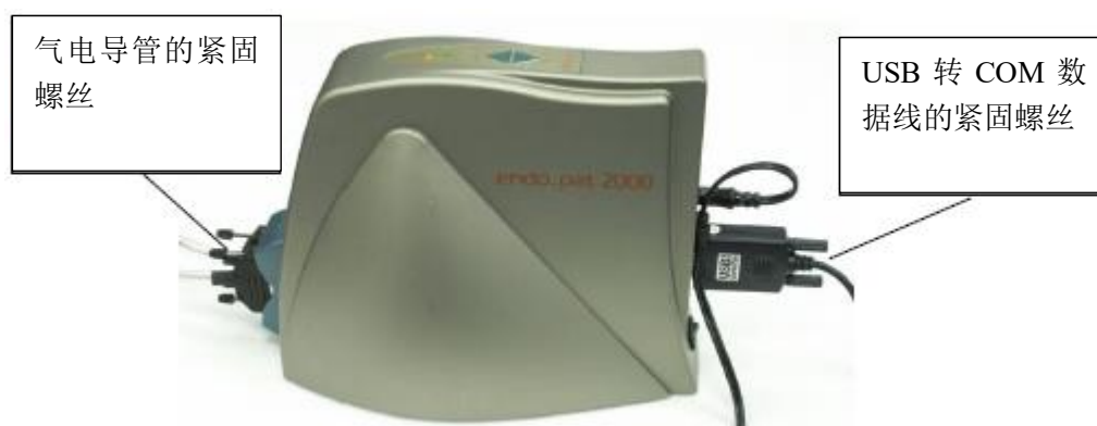
图 3 – 气电导管和 USB 数据线的连接
