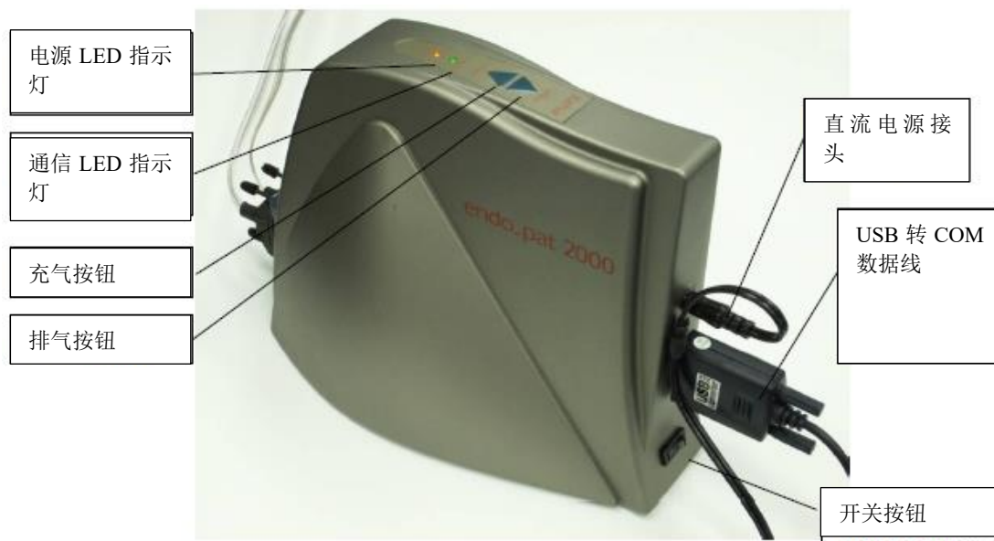
图 2 – Endo PAT™2000 血管内皮功能测试仪
