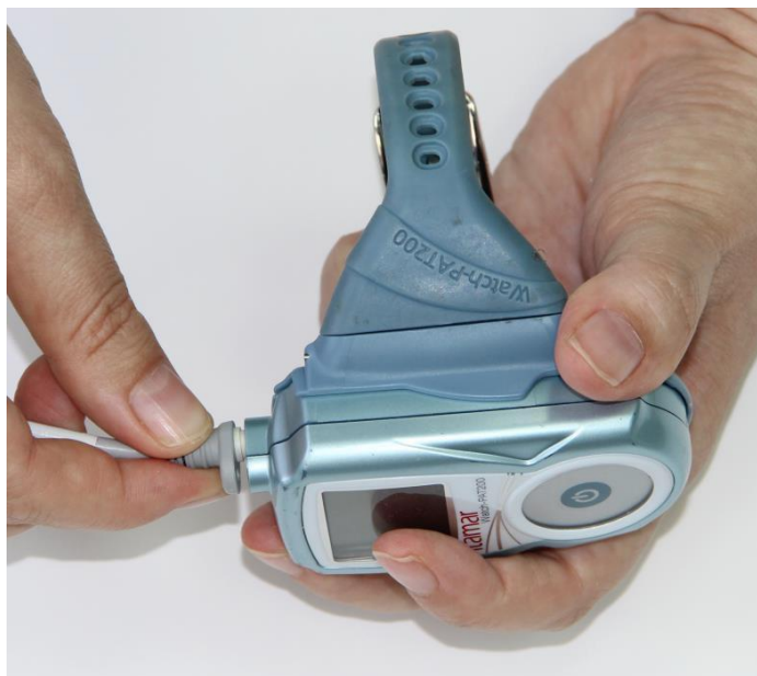
Figura 18 – Substituir a sonda uPAT
