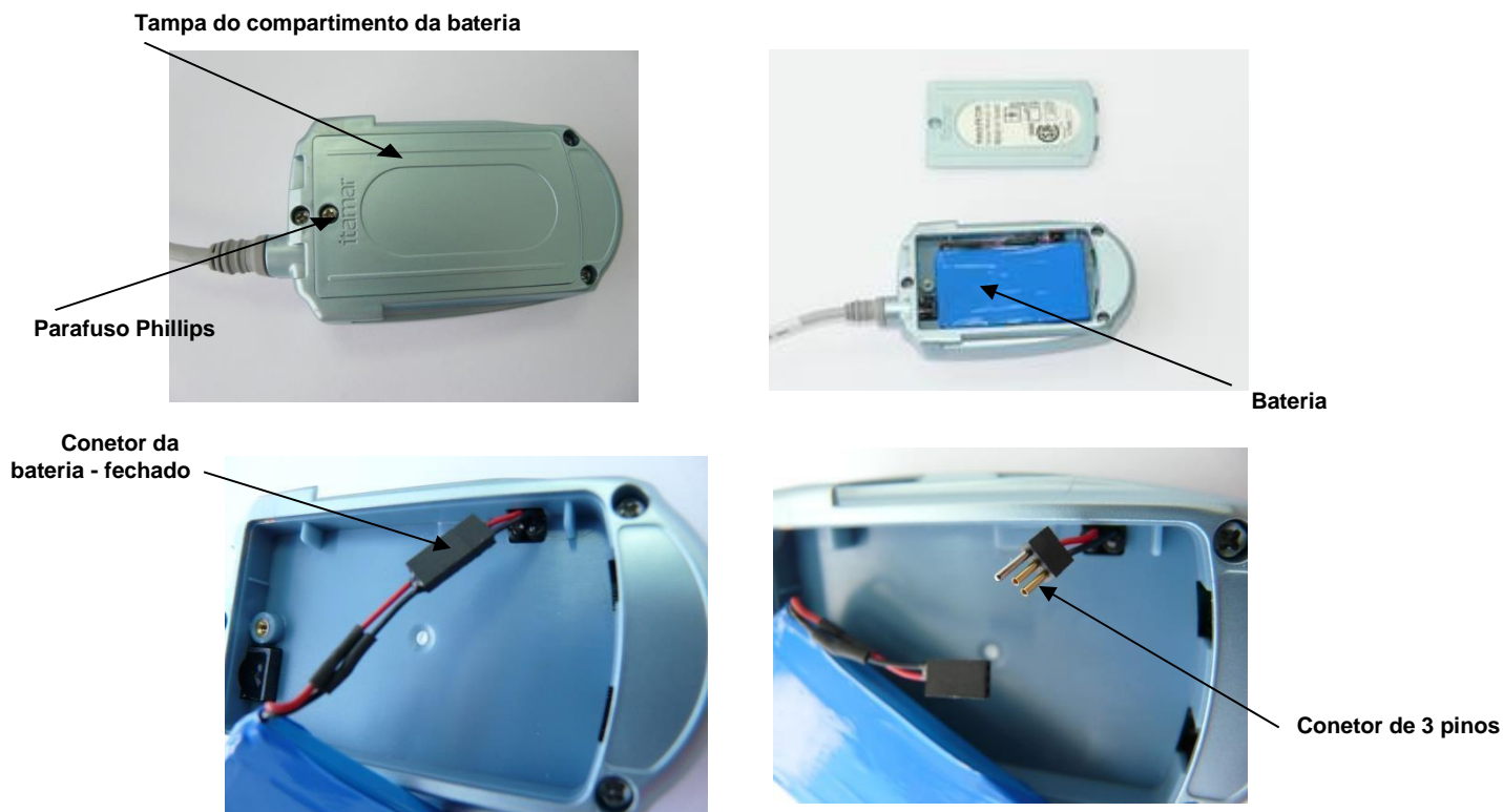
Figura 19 – Substituir a bateria
